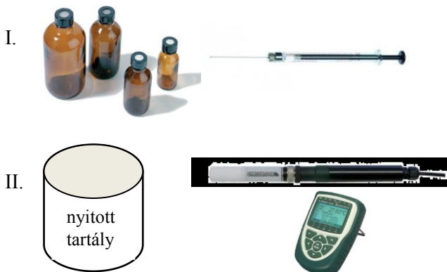
1. ábra: A must erjesztése során keletkező CO 2 -koncentráció mérése zárt és nyitott körülmények között
