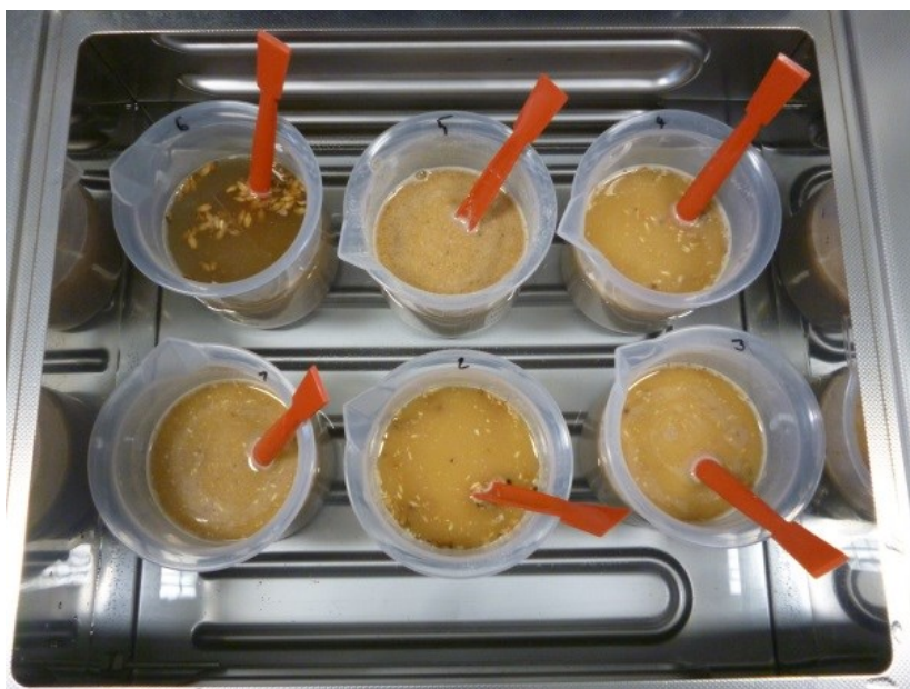
1. ábra: Laboratóriumi körülmények között sörle készítés vízfürdős termosztátban
