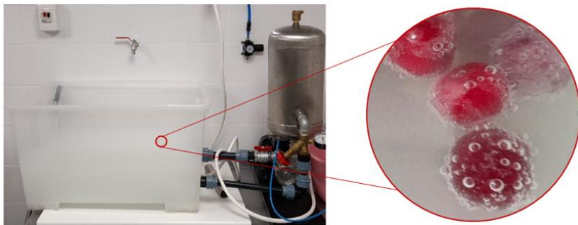
2. ábra: Mosóberendezés fényképe működés közben (meggy szemekre tapadt mikrobuborékok)
